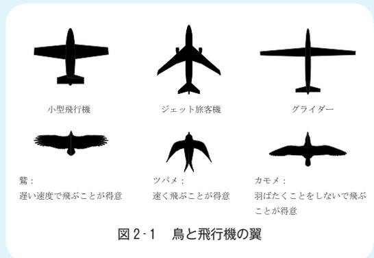
図2-1 鳥と飛行機の翼
