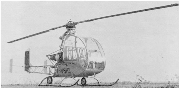
図 1-5 翼端駆動式 (シュド・ジン)
