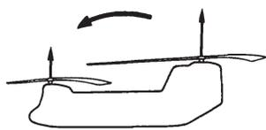
図 1-11 タンデム・ロータ式の縦の操縦
