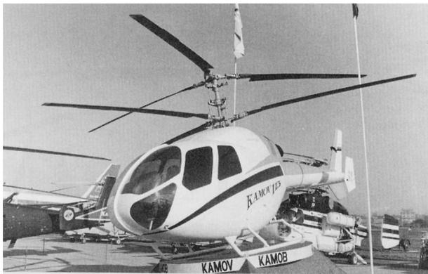
図 1-8 同軸反転ロータ式 (Ka-115)
