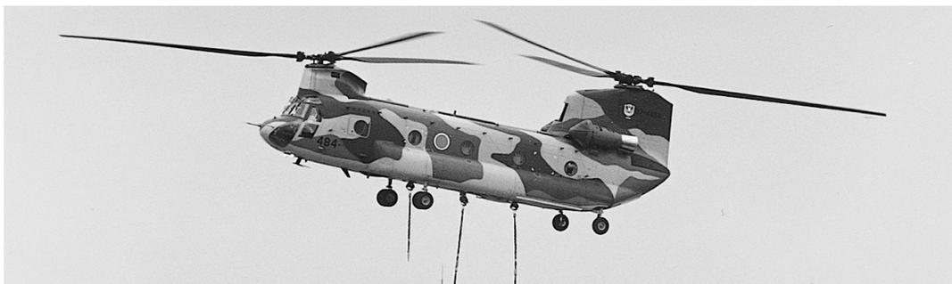
図 1-10 タンデム・ロータ式 (CH-47)
