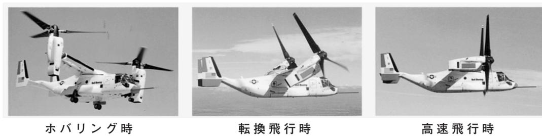
図 1-18 ティルト・ロータ機 (V-22)
