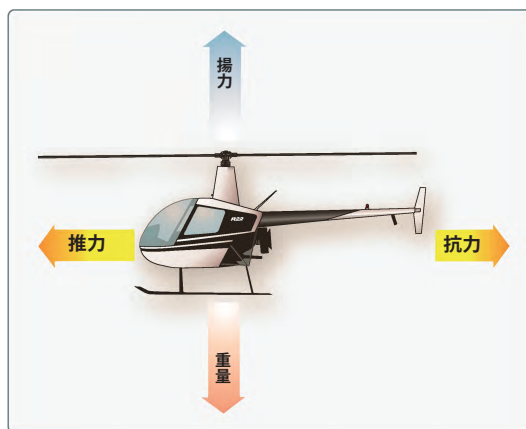
図 2-1 : 前進飛行するヘリコプターに作用する4つの力
